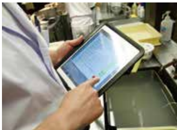
i-Reporterが搭載されたiPadは、防水、防塵処理がなされたカバーで保護されている
